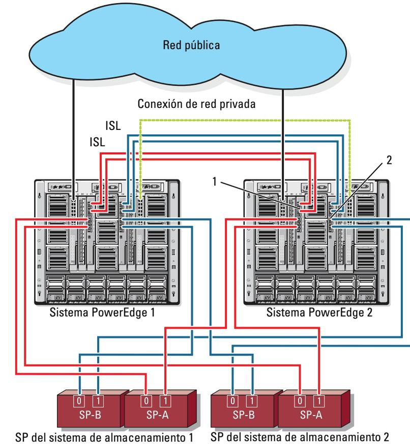
1 Módulo de conmutador Fibre Channel (2)
